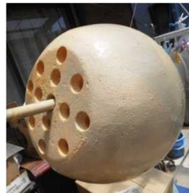
材料は厚み50mmの発砲スチロール。ドーナツ型に切った部品5枚を重ねて糊付け。後はサンドペーパーで滑らかな曲面を削り出す。
